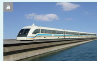
Trenurile maglev bazate pe levitația magnetică (o tehnologie care utilizează forțele magnetice pentru a ridica și propulsa un vehicul).
