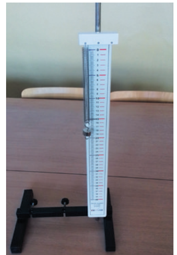
6 Dispozitiv experimental pentru studiul forțelor
