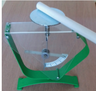
a Încărcarea electroscopului prin contact
