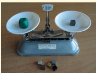
6 Balanță pe ale cărei talere se află cuburi de volum diferite
