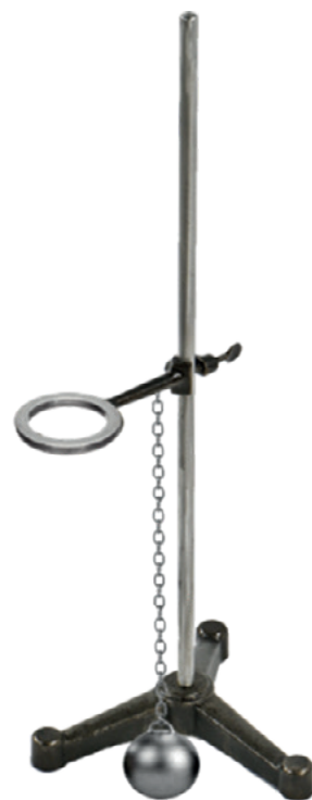
1 Dispozitiv pentru observarea dilatării metalelor
