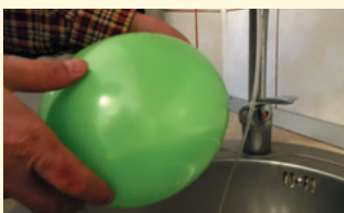
6 Electrizare prin influență între un balon electrizat și jetul de apă
