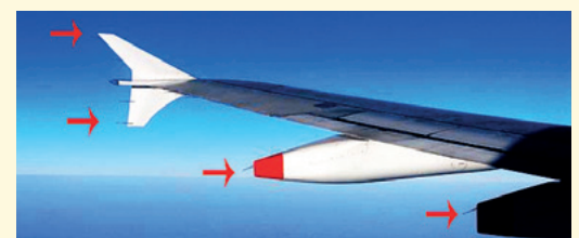
Tije metalice ascuțite montate pe un avion
