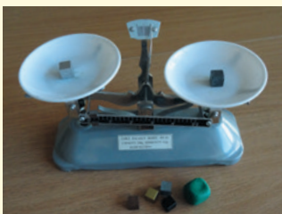
5 Balanță pe ale cărei talere se află cuburi de volum egale
