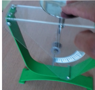
b Descărcarea electroscopului
