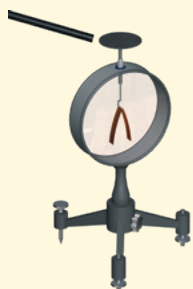
3 Electroscoop cu două foițe metalice și bară metalică
