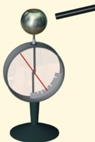
4 Electroscoop cu lamelă mobilă și bară metalică
