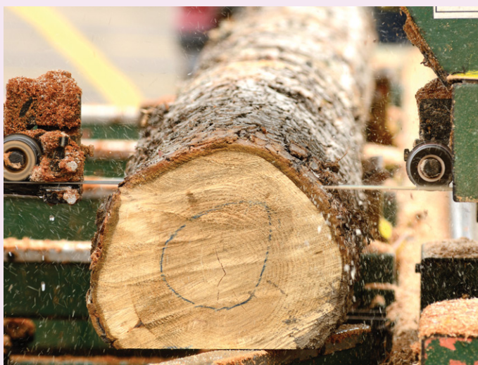
Fierăstrău într-o mică fabrică de cherestea din Oregon, folosit pentru tăierea unui buștean de cedru.
