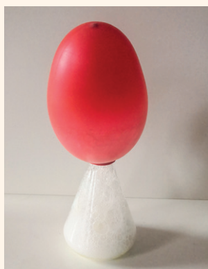
Evidențierea degajării dioxidului de carbon
