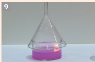
Reacția sodiului cu apa
